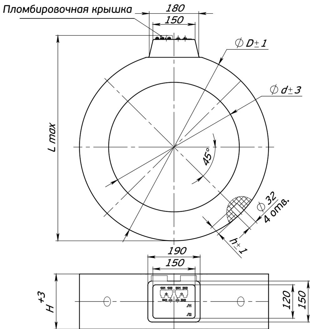
Рис. 3 - Общий вид трансформаторов тока ТШЛ-СВЭЛ-20-2(3,4,5)
