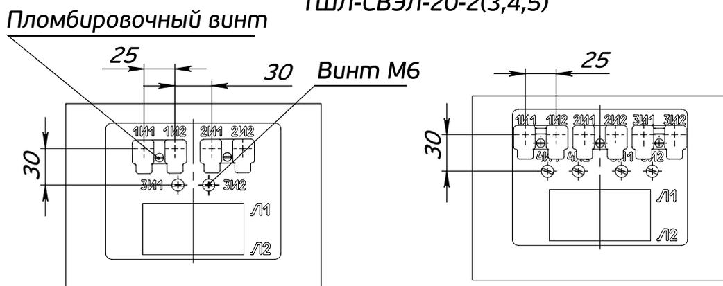
Рис. 4 - Панель контактов трансформаторов тока ТШЛ-СВЭЛ-20-3
