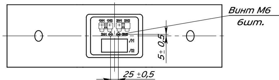
Рис.2-Общий вид трансформатора ТШЛ-СВЭЛ-20-3
